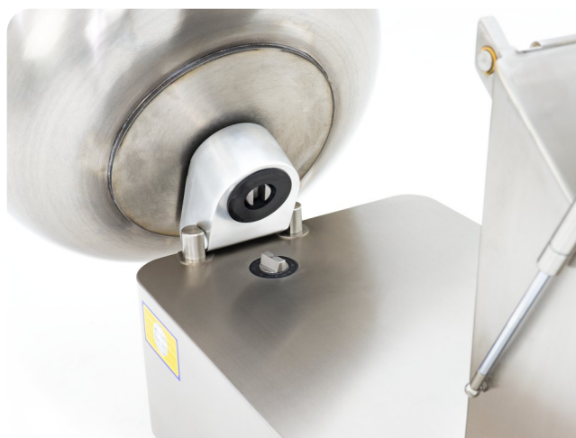
P und PV Modelle: motorisierte Schüssel für noch gleichmäßigeres Mischen, Empfohlen für kleine Portionen.
