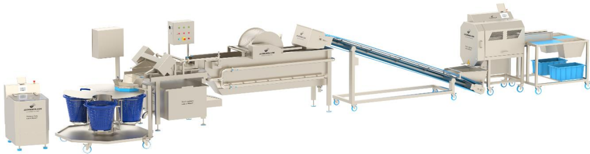
HS-FLEX in einer Gemüseverarbeitungslinie zum Schneiden, Waschen und Trocknen von Gemüse
