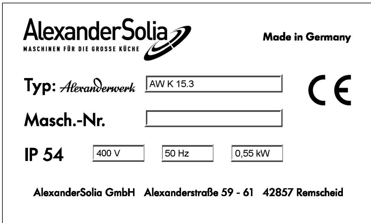
Abbildung 2-1: Typenschild und CE-Kennzeichnung
